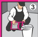
**3** Для подготовки раствора залейте водопроводную воду комнатной температуры в чистую ёмкость из расчёта 5,0 - 5,7 л воды на 1 мешок (25кг).
